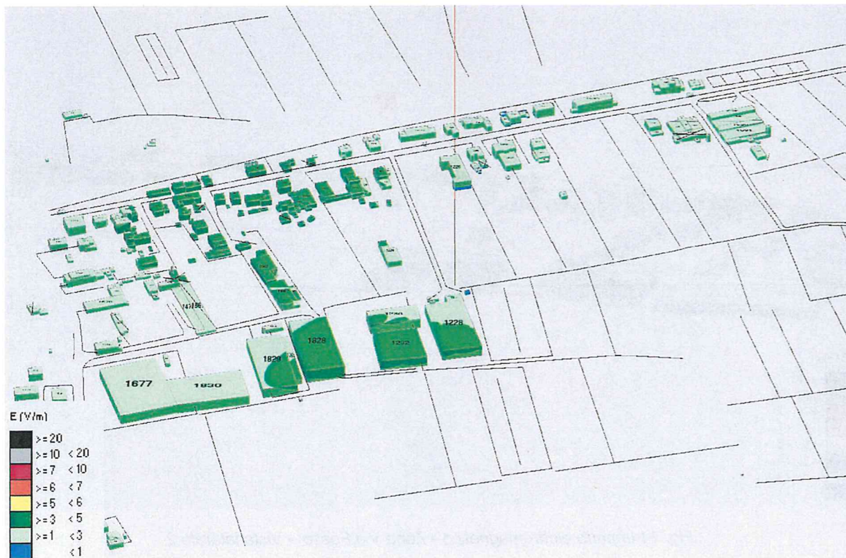
Fig. 12 Impatto elettromagnetico - Zona Via Fosso - 0°/Nord Vista 2
